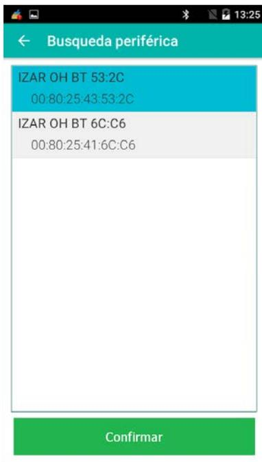
En esta ventana, puede emparejar una cabeza óptica IZAR OH BT para realizar una lectura de radio de los productos Diehl Metering (protocolos PRIOS, REAL DATA y OMS).
