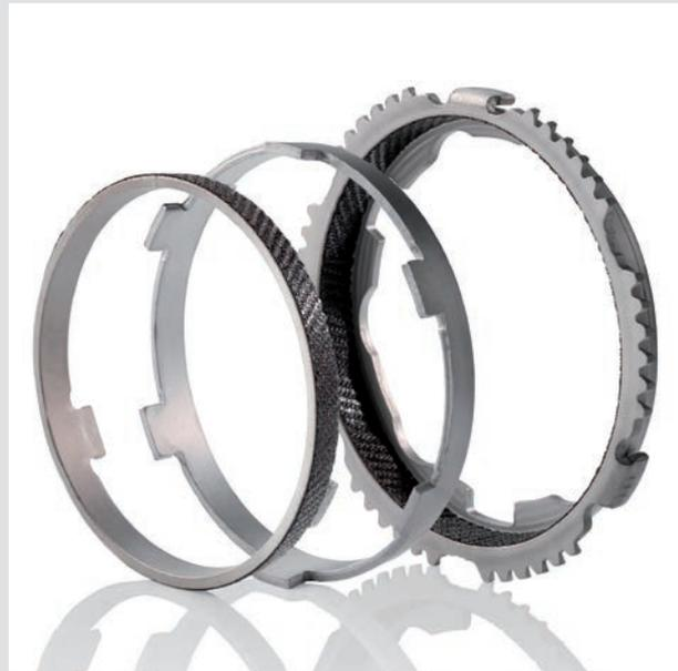
Für Hochleistungsgetriebe empfehlen wir unsere Synchronringe aus Stahl. Diese werden im Gegensatz zum herkömmlichen Messing-Synchronring durch Blechumformung hergestellt.
