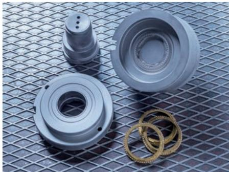
Sämtliche Werkzeuge für das Schmieden, die spanende und spanlose Formgebung sowie alle Lehren und Vorrichtungen werden selbst entwickelt, konstruiert und im hauseigenen Werkzeugbau angefertigt.
