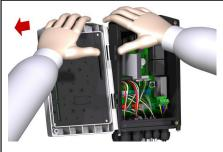
Wenn das Rechenwerk getauscht werden muss (z.B. nach Ablauf der Eichperiode), ist dies mit wenigen Handgriffen rasch und einfach möglich.
