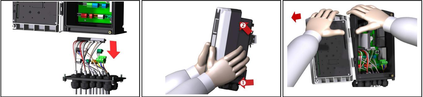
Wenn das Rechenwerk getauscht werden muss (z.B. nach Ablauf der Eichperiode), ist dies mit wenigen Handgriffen rasch und einfach möglich.
