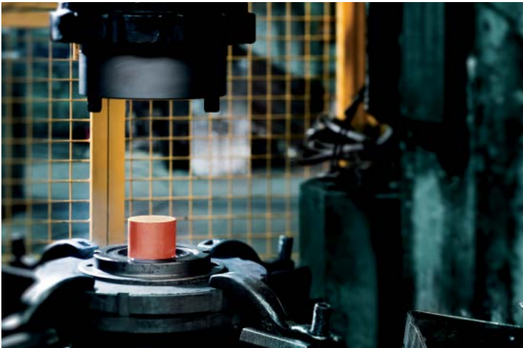
Einlegen des auf Temperatur gebrachten Schmiederohlings
