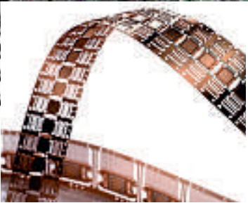
Stanzteil mit Folgebundwerkzeug gestanzt
