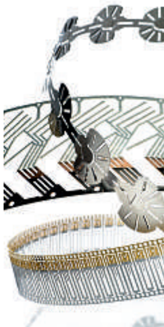
Hochgeschwindigkeitsstanzen Selektiv-Veredelung mit Nickel-Phosphor
