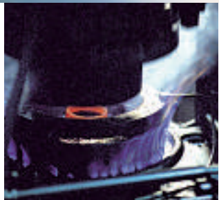
Schmiedeprozess der Messing-Synchronringe
