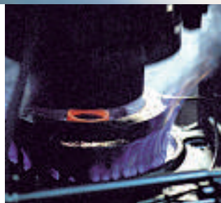
黄铜变速器同步环的锻造过程
