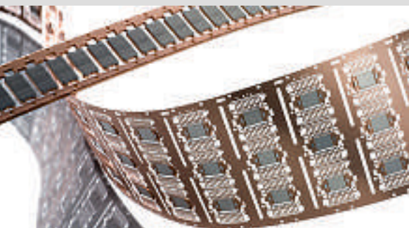
经过表面处理后的精密冲压零件
