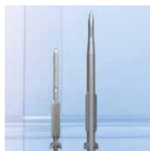
Lenkflugkörper für die bodengebundene Luftverteidigung (von links): IRIS-T (kurze Reichweite) IRIS-T SL (mittlere Reichweite).
