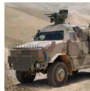
Counter-IED: Fahrzeug mit frontmontiertem HPEM<sup>1</sup>-Wirksystem zum Schutz militärischer Konvois vor Sprengfallen.
