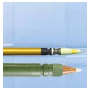
Lenkmunition VULCANO in der Ladekonfiguration: Kaliber 127 mm (oben), Kaliber 155 mm (unten).
