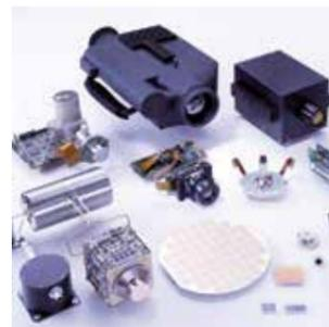
Das Sortiment von AIM Infrarot-Module für militärische Anwendungen reicht von Infrarot-Detektoren über Stirling-Kühler bis zum Wärmebild- und Zielgerät.
