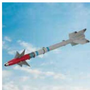
Laser-Guided Sidewinder – Luft-Boden-Lenkflugkörper mit Semi-Active Laser zur Bekämpfung von Landzielen für verschiedene Trägerplattformen.
