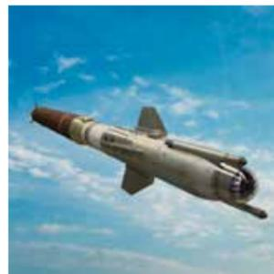
Der RAM-Block-2-Lenkflugkörper verfügt über einen leistungsgesteigerten Radarsuchkopf und eine erheblich höhere Agilität.
