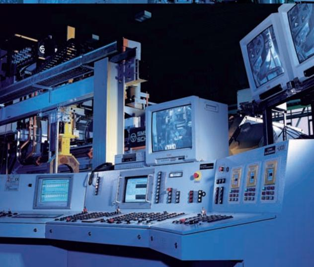
Steuerstand der 35 MN-Indirekt-Strangpreßanlage
