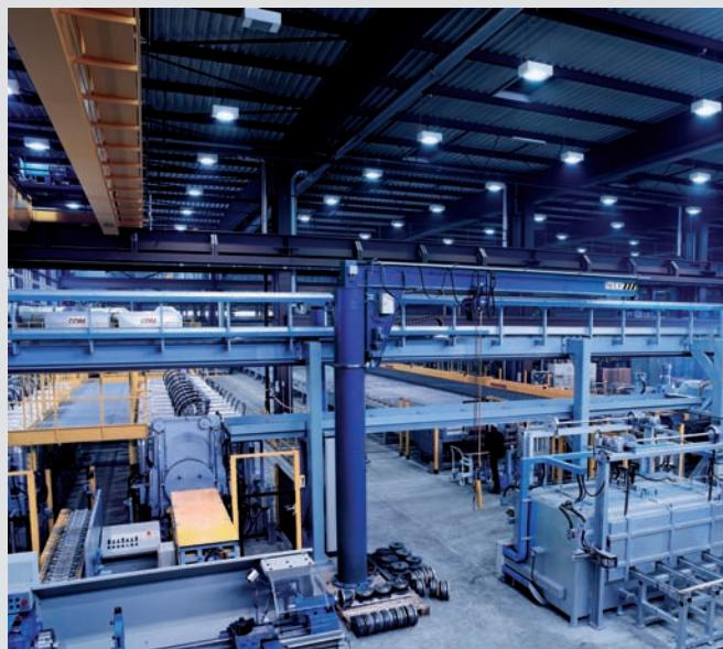
Die 2004 installierte neue Strangpressanlage mit einer Kraft von 3500 t garantiert eine hohe Produktivität bei gleichbleibend hervorragender Produktqualität.
