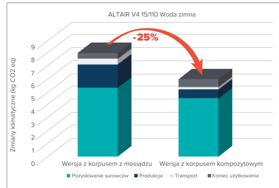
ALTAIR V4 15/110 Woda zimna porównanie między kompozytem a mosiądzem
