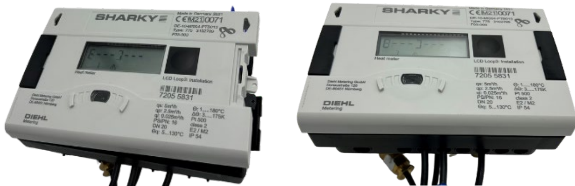
Figure 8 Fermeture du boîtier du compteur en commençant par la gauche puis Fermeture du boîtier du compteur avec les loquets latéraux
