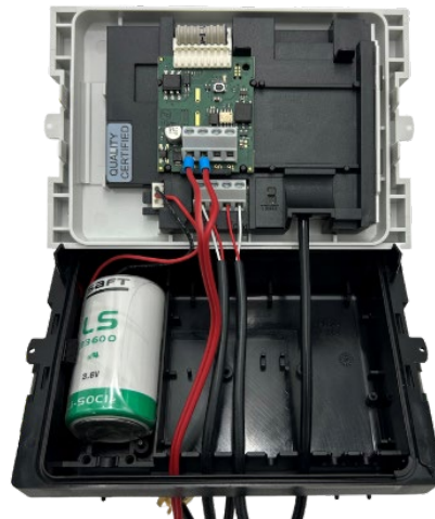
Figure 5 Exemple de câblage de l'alimentation
