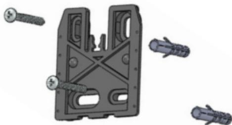
1. Befestigen Sie die Wandhalterung lagerichtig mittels der beiden Schrauben (Dübel) an einer Wand.
