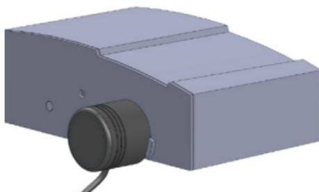
Zur korrekten Programmierung müssen Sie den Optokopf auf die optische Schnittstelle des Moduls aufsetzen (der Optokopf haftet selbstständig).
