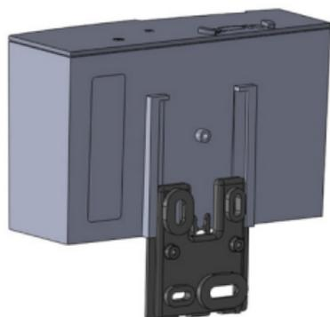
2. Schieben Sie das Modul von oben in die Montageplatte bis dieses in der Rastnase einrastet.
