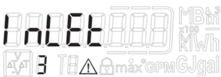
**i** Ved ændring af installationspositionen, skal den aktuelle installations følere tilpasses, (se kapitel 4).
