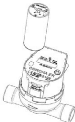
Zur korrekten Konfiguration muss der Optokopf auf die optische Schnittstelle gesetzt werden.
