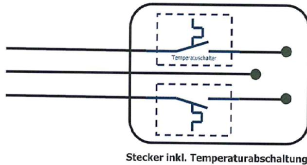
Ein Stecker mit zwei integrierten Temperaturschaltern ermöglicht ein sicheres Abschalten im Fall einer gefährlichen Überhitzung, eine zusätzliche Absicherung durch Software ist nicht erforderlich. Da ein zweiter Temperaturschalter benötigt wird, sind die Kosten höher als bei der Variante mit nur einem Temperaturschalter.
