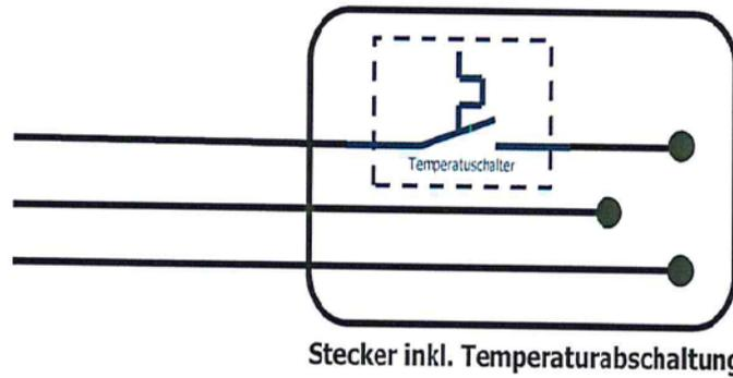
Eine kostengünstige Variante ist ein Stecker mit nur einem Temperaturschalter. Für ein sicheres Abschalten ist allerdings zusätzlich eine softwareseitige Erkennung der Phase („Loss of Phase“) erforderlich.
